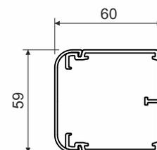
Produktbeschreibung: geeignet zur Verlegung von Niederspannungsleitungen
