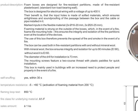
classification: EI 15 - EI 90 ČSN EN 1363-1:2013, ČSN 73 810, ČSN EN 1363-1:2013, ČSN EN 1366-3:2023, ČSN EN 1364-1:2017
