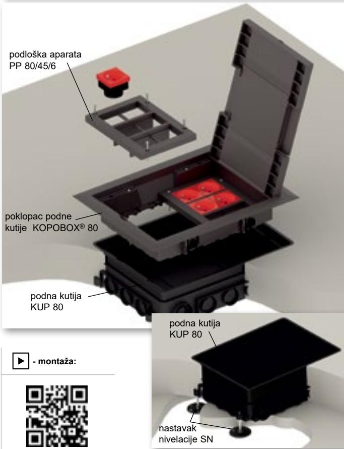
Kompletno sastavljena podna kutija složena iz KOPOBOX® 80 i KUP 80 je predviđena za instalaciju klasičnih i modularnih aparata. Izbor tipa instaliranih aparata je omogućen prema podloški aparata 45x45. Pričvrstno podnožje (predviđeno za montažu u pomicne podove) se kod instalacije okvira KOPOBOX® 80 u kutije KUP 80 ne koriste.
